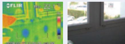
Figure 7 : Analyse thermographique des parois
